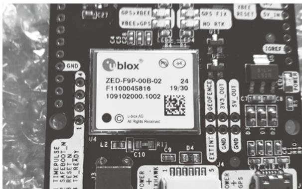
RTKの場合の精度は、14mm以内となっています。PPPにも対応していて今後みちびきのCLAS（センチメータ級測位補強サービス）が本格運用するようになれば、単独でも 6 cmの精度が可能となる予定です。
